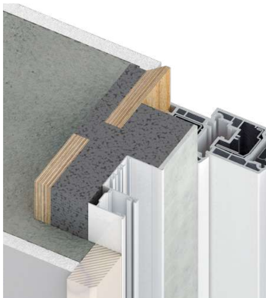
Fig. Sezione del telaio Tipo 10 MAXI.
